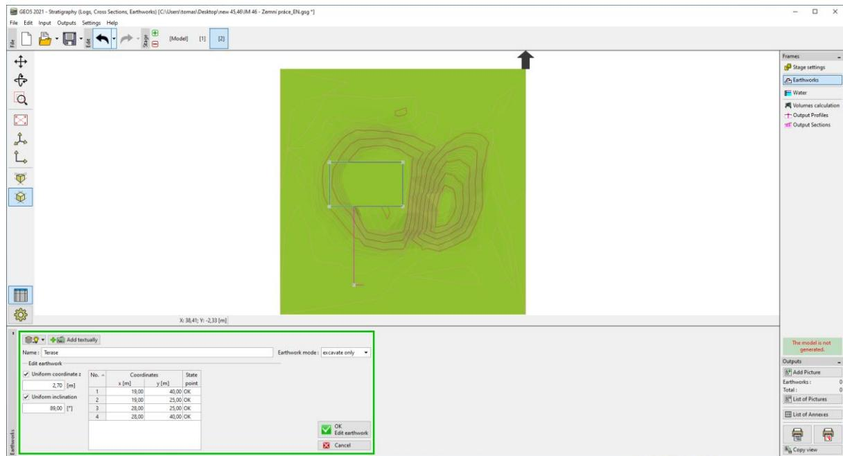
Kreirana konstrukcija će biti generirana nakon unosa. Vanjska konstura zemljanih radova iskopa prikazana je crvenom bojom.
