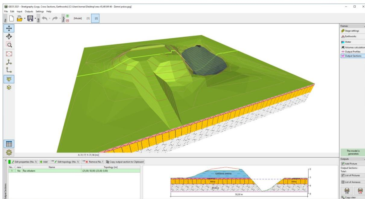
U kartici „Construction Site“ unijet ćemo dimenzije modela. Prepostaviti ćemo pravokutni oblik duljine 50 m. Minimalne x i y koordinate će stoga biti 0m i maksimalne 50m.
