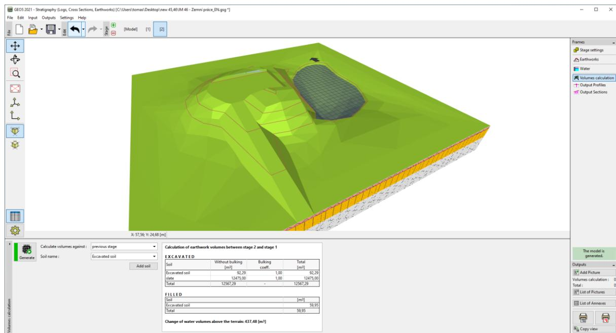
Prelazimo na karticu „Output Sections“. Ovdje ćemo spremiti poprečni presjek u međuspremnik, klikom na tipku „Copy output section to Clipboard“.
