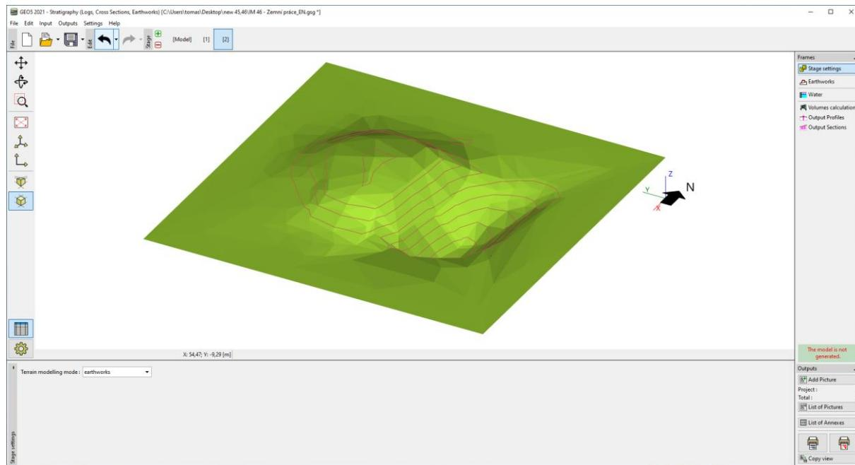
U kartici „Earthworks“ unesite oblik terase. U našem slučaju odabrat ćemo pravokutni oblik, sa sljedećim koordinatama: [19;40], [19;25], [28;25], [28;40] i visinom 2,7m. Pošto će rub biti vertikalni, unijet ćemo nagib od 89 stupnjeva. (ne može biti uneseno 90 stupnjeva, zbog principa konstrukcije). Unesite preinake kao „only excavate“ – preinaka će samo ukloniti tlo.
